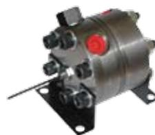
FMR系列齿轮式高压流量计，挤压铸铁壳体，硬质不锈工具钢齿轮，配用巴鲁夫传感器，耐压达500bar，测量误差小于 $\pm 1\%$ 。适用各种介质，流量范围：0.5-27L/min。
